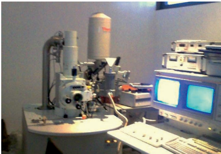
Figura 5.5. Equipo de Microscopía Electrónica de Barrido JEOL 6300.
