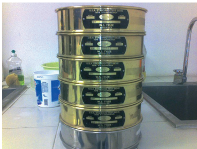
Figura 5.16. Juego de tamices utilizados para efectuar el análisis granulométrico.
