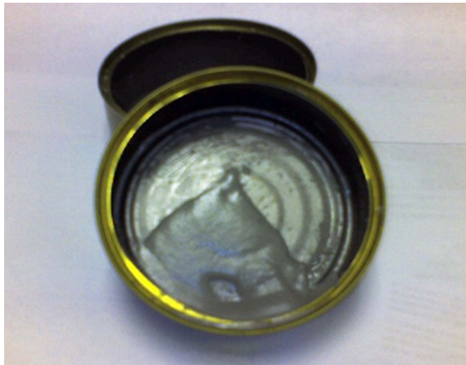
Figura 5.12. Instrumento usado para determinar la absorción de aceite.
